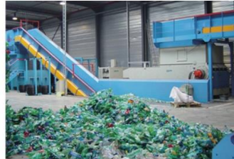
PET-Flaschenfraktion 6,0to/h Granulat <60mm
