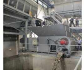
Mischkunststoffe 7,0to/h Granulat <60mm
