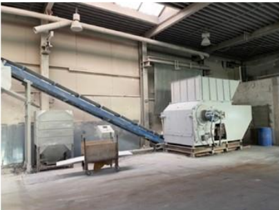
Zerkleinerung Mehrkanntrotor PRC730 PE, PVC Profile, Kundenversuche
